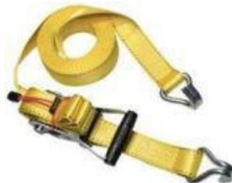
Los tensores y correas son la elección más acertada para sujetar y transportar diferentes objetos. Alta seguridad y sujeción gracias a su gran resistencia. Longitud 3 m., ancho: 25 mm., resistencia 1360 kg. Longitud 4,5 m., ancho 35 mm., resistencia 2500 kg. Longitud 8,5 m., ancho 50 mm., resistencia 4500 kg.
