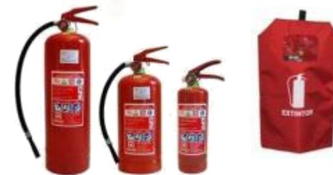
Cuerpo: de Chapa laminada DC - 04 - en 10130. Válvula de disparo de Latón. Tubo sifón en PVC. Manguera de polietileno. Difusor de polipropileno. Manómetro comercial s/norma. Capacidad de 1 - 2 - 6 - 9 kilogramos.
