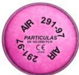
Filtro de alta eficiencia P3 reutilizable para todo tipo de partículas y recomendado contra niveles molestos de vapores orgánicos. Eficiencia mínima de retención de partículas de un 99,95%. Diseño plano y liviano con excelente distribución de peso. Conexión tipo bayoneta compatible con todas las series de respiradores AIR.
