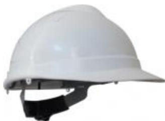
Producido en PHAD polietileno de alta densidad y resistencia al impacto y de baja degradación. Arnés fabricado en polietileno de gran ductibilidad y resistencia. Posee 4 puntos de sujeción y ajuste tipo Roller.
