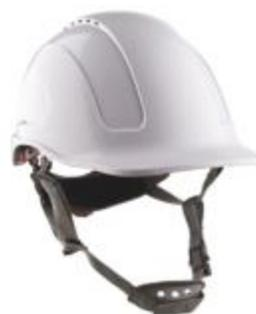
Para trabajos en altura, está diseñado de termoplástico de ingeniería ABS de alta resistencia a impactos. Posee ventilación lateral, suspensión tipo Roller, barboquejo de cuatro puntas y visera corta para trabajos en altura.
