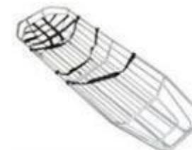
Camilla metálica con forma de canasto. La camilla es utilizada en múltiples situaciones de rescate de progresión vertical, ya que es posible asegurar cintas y cuerdas. Su forma impide la caída del herido. Elaborada completamente en acero cincado blanco con soldaduras reforzadas.
