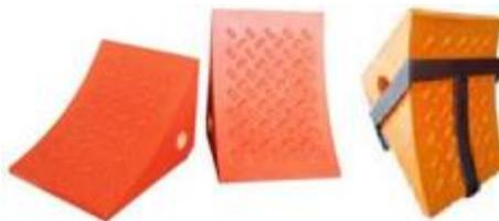
Cuña de poliuretano. Diseñada para camionetas y camiones de servicio minero. Son de obligación para el transporte minero, según norma 92 para vehículos de más de 3500 kg. de masa máxima autorizada cuando se para o estaciona en lugares con pendiente.
