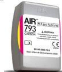
Filtro de alta eficiencia P3 reutilizable para todo tipo de partículas y recomendado contra niveles molestos de gases ácidos y vapores orgánicos. Diseño protegido que canaliza el flujo de aire resultando en una mayor duración del filtro frente a salpicaduras y chispas. Eficiencia mínima de retención de partículas de un 99,95%. Conexión tipo bayoneta compatible con todas las series de respiradores AIR.
