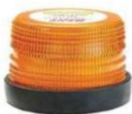
Balizas estroboscópicas. Base de caucho. Circuito electrónico sellado con epoxi, que lo hace resistente a vibraciones. Mica de policarbonato reforzado. Rango de voltaje 12 a 48 v. FPM: 65. ± 3 a 3 joules.
